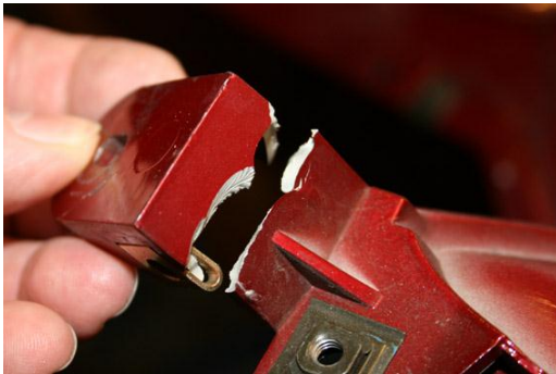
Die zu reparierende abgerissene Halterung
