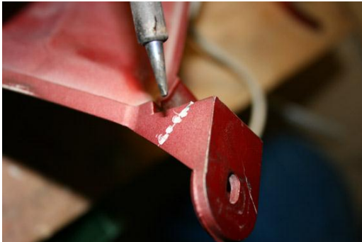
Halterung mit ein paar Lötunkten fixieren. Hierzu einfach die Teile zusammenhalten und den Kunststoff am Riss mit der LötKolbenspitze zum Schmelzen bringen.
