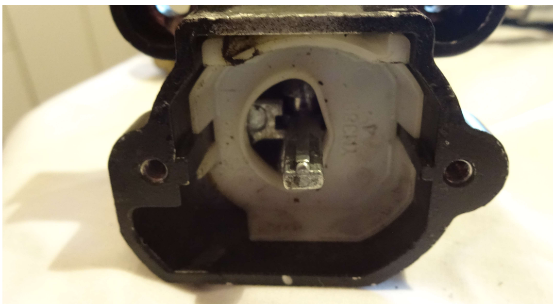
Zündschloss nach Entnahme der elektr. Teile
